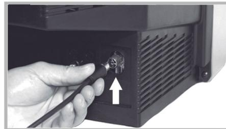
B. Conéctela a su televisor. Conecte el final del cable coaxial en la ranura RF de entrada de su televisor
