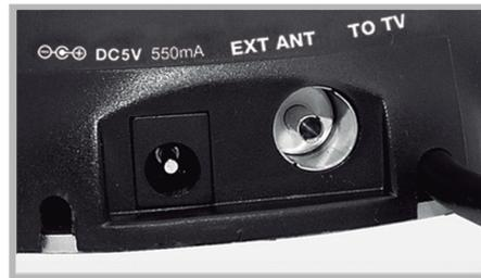
A. Conecte el alimentador a la corriente eléctrica (AC) y la salida del cable en la ranura de entrada (DC) de la antena
