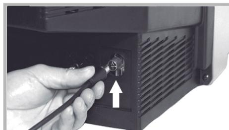
B. Conécte la antena a su televisor. Conecte el final del cable coaxial en la ranura RF de entrada de su televisor
