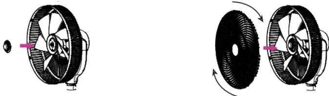
Coloque la rejilla delantera haciendo coincidir el agujero de la parte inferior de ambas rejillas, despues atornille para sujetar ambas partes.
