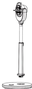
Coloque el brazo del motor en la base uniendo el conector de la base con el conector del brazo motor. Solo puede ponerse en la posición correcta, no fuerze la entrada del brazo.
