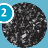
Filtración por carbón activo: elimina el sabor desagradable del agua; elimina pesticidas y contaminantes residuales; elimina sustancias nocivas como el cloro y los tetracloroetileno.
